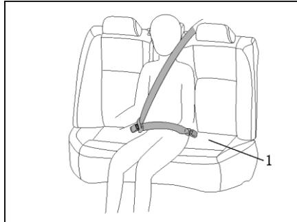
Ремень безопасности среднего заднего сиденья двухточечный или трехточечный с двумя замками. Для нормальной работы ремня безопасности необходимо использовать оба замка, вставив в них язычок ремня и надежно его зафиксировав.
